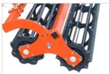
Double cage roller ø 400mm (tube/flat) - 160 kg/m
